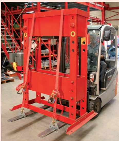
Ladungssicherung mit Gabelklemmen und Spanngurten
