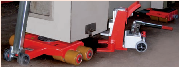
Kugelgelagerte Rollen garantieren einen leichten Lauf
