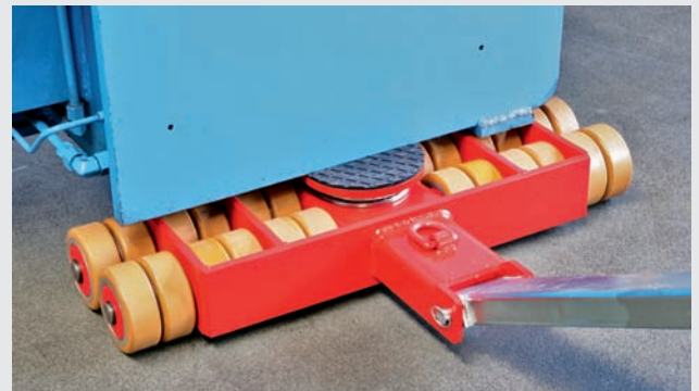
Lenkwerk der G-Serie im Einsatz
