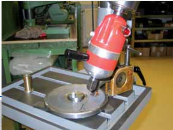
Erodování šikmých vrtaných otvorů.
