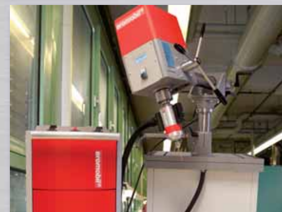
Erodování v každém úhlu, případně velkých konstrukčních částí na radiální erodovací jednotce.
