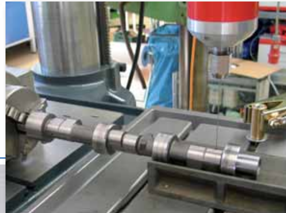
Erodování vačkové hřídele.
