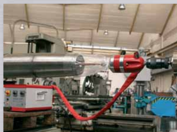
Horizontální erodování na horizontální vrtačce a frézce. Místo vrtáku je do stroje upnuta kyvná hlava erodovacího přístroje.
