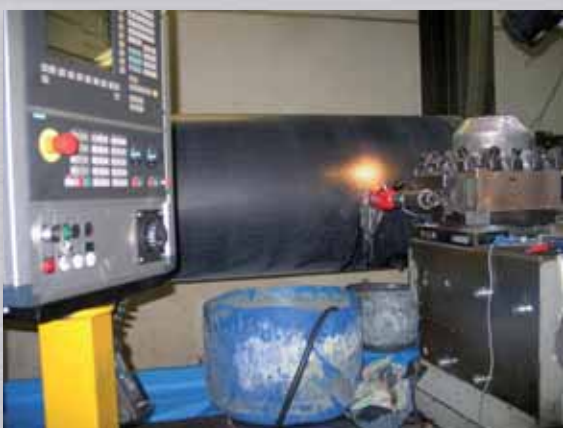
Erodování na CNC soustruhu. Regulace posuvu nastává manuálně pomocí ručního kolečka.
