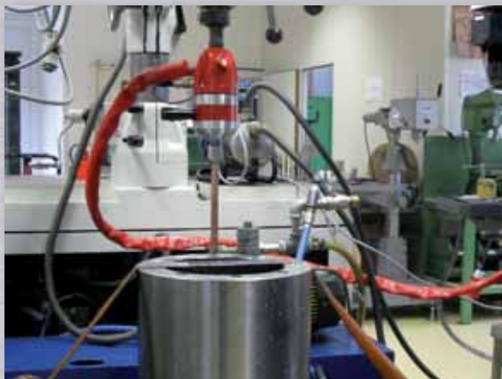
Zlomený závitník v chladicím vodním plášti, erodování s automatickým posuvem.
