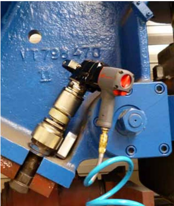
Die Pneumatikschrauber sind im hohen Maß flexibel einsetzbare 2-Gang-Montageschrauber, mit manueller Umschaltung vom Schnell- in den Lastgang. Im Drehmomentbereich von 40 bis 12.000 Nm. |
