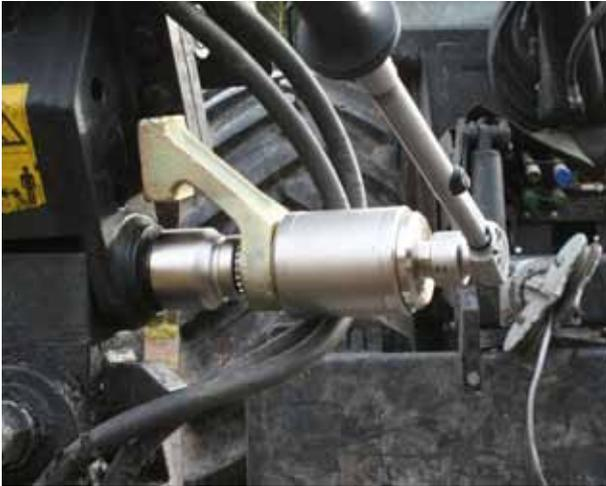
Mechanische JUWEL-Kraftschrauber verfügen über eine Genauigkeit von  $\pm 2\%$  bei gleichem Schraubfall. Sie können selbst schwerste Schraubvorgänge leicht, schonend und unfallsicher bewältigen. Mit ihnen ist ein effektiver Betrieb beim Lösen und Anziehen von Schraubverbindungen möglich, denn sie sind überall und zu jeder Zeit einsatzbereit. Zudem sind sie kostengünstig im Einsatz. |
