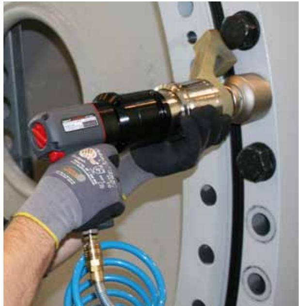
Die **JUWEL**-Pneumatik-Kraftschrauber zeichnen sich u. a. durch einfache und sichere Handhabung sowie vibrationsfreie und geräuscharme Antriebstechnik aus. Die Feineinstellung erfolgt über eine externe Wartungseinheit für pneumatische Drehmomentschrauber. Der ergonomisch geformte 360°-drehbare Pneumatik-Antrieb mit bedienerfreundlicher Rechts-Links-Umschaltung ermöglicht ein rationelles und sicheres Arbeiten. |
